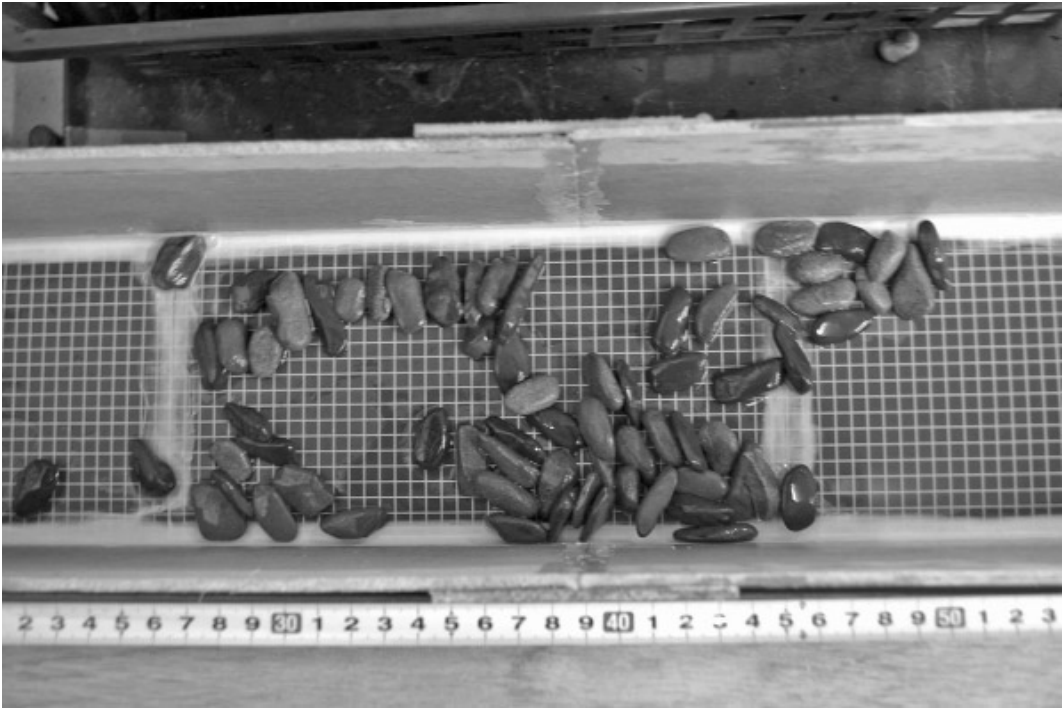
写真3：簡易実験水路における中礫（流下方向は写真の右側から左側）
