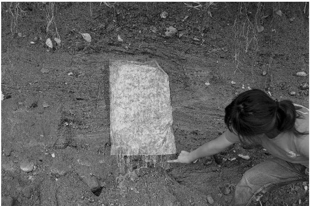
写真2：「トマック ns-10」を用いた斜交葉理を含む「地層はぎ取り法」
