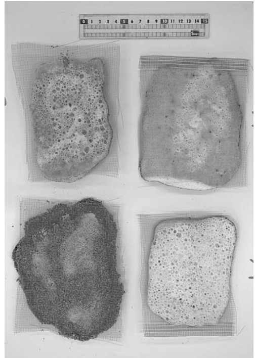
写真10：「トマック ns-10」を用いた砂の固定 (ネット裏面)
